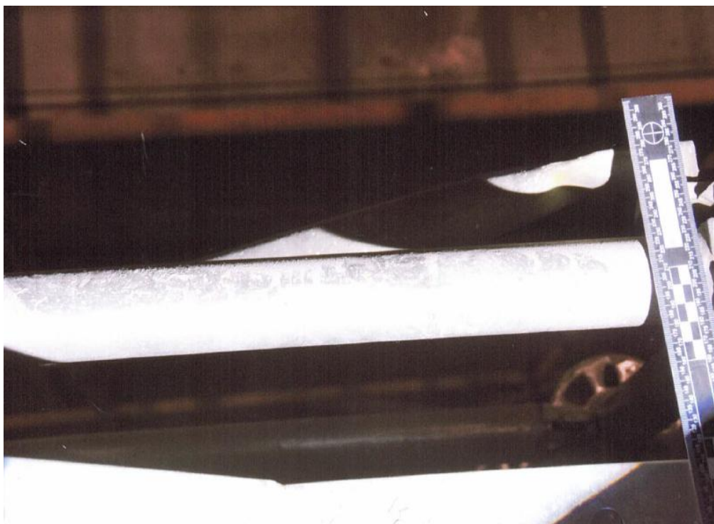
第四级楼梯与第五级楼梯连接处平台东侧上方护栏擦蹭痕迹
