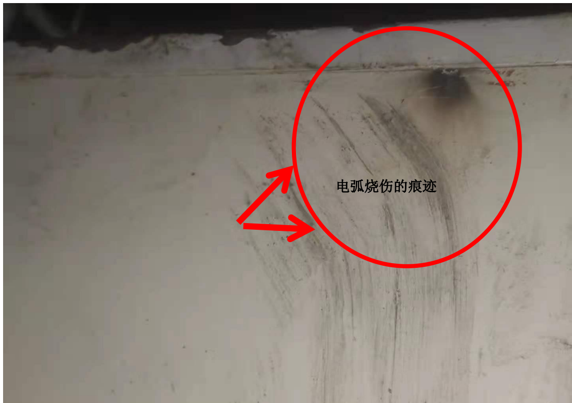
电缆槽盖板边上发现电弧烧伤的痕迹
