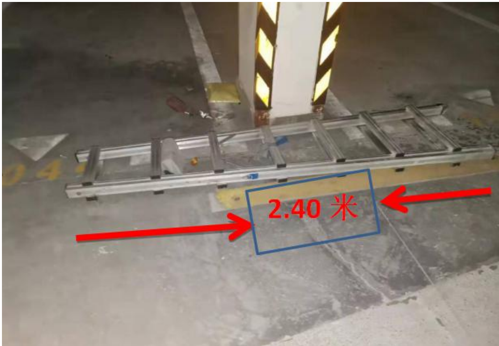
(图九) 事发时李某露使用的铝合金梯 (长度为 2.4 米)
