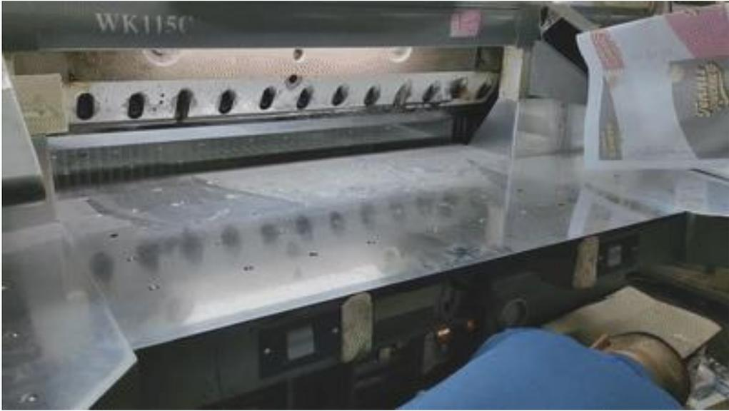
图9 测试中间继电器触点粘连时切纸机下刀
