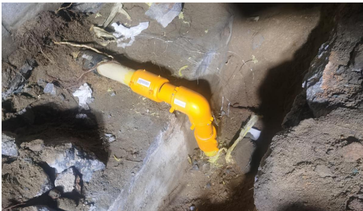
图 2 燃气泄漏管段图
