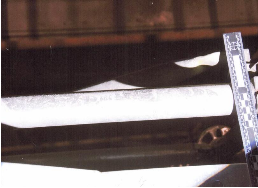
第四级楼梯与第五级楼梯连接处平台东侧上方护栏擦蹭痕迹
