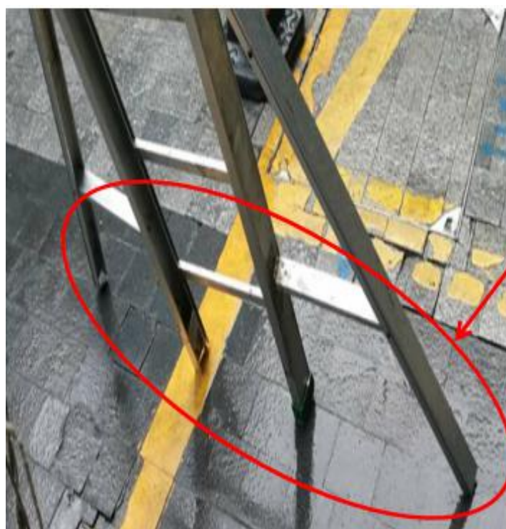
伸缩式人字梯底部有多处防滑垫脱落
