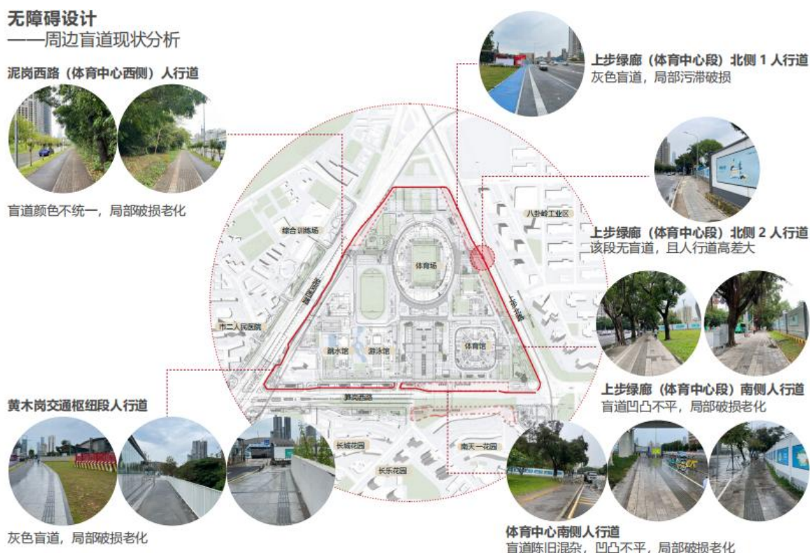
图 6-23 周边盲道现状
